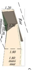
Les coffres de branchements de réseaux et la boîte aux lettres devront être intégrés dans un mur ou un encadrement bois (implanté à l'alignement) d'une hauteur de 1,20 m
